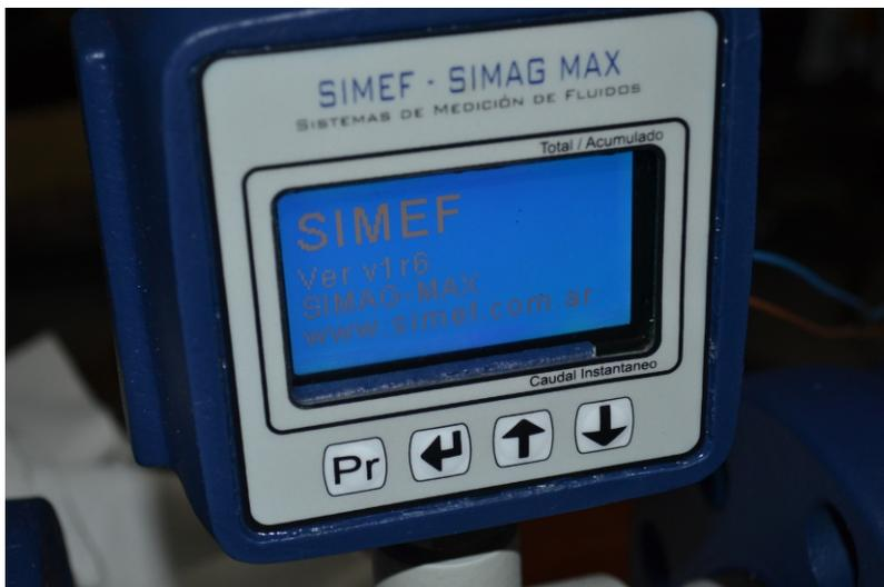
Se le incorporó un display gráfico grande retroiluminado de 45×65 mm, donde figurara no solo caracteres alfanuméricos, también símbolos de cualquier tipo según sea programado. Cuenta con acceso mediante password para usuarios de confianza en la configuración de los parámetros, y password programado de fábrica para cambio de caracteres y visualización de la información.
